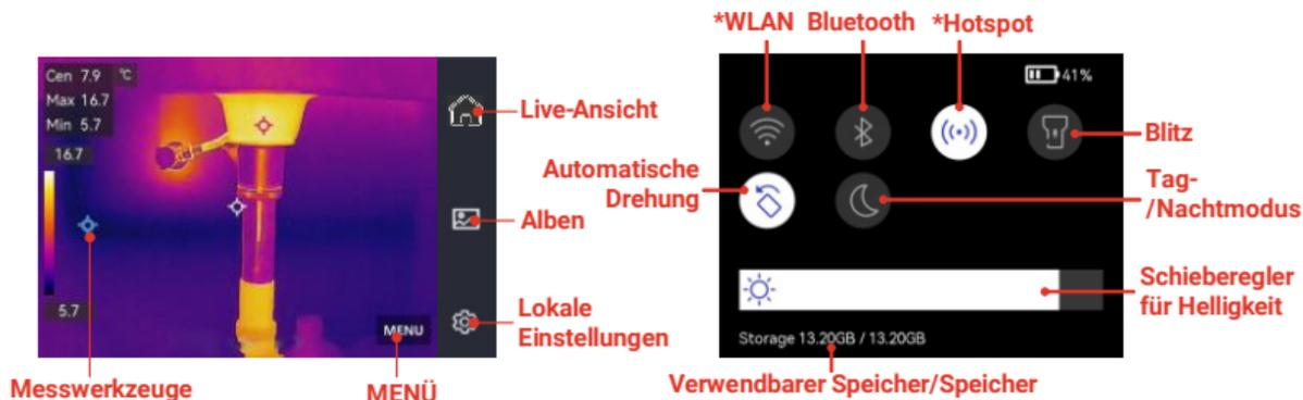
\*WLAN und \*Hotspot werden nur von bestimmten Modellen unterstützt. Orientieren Sie sich bitte am jeweiligen Kameramodell.
